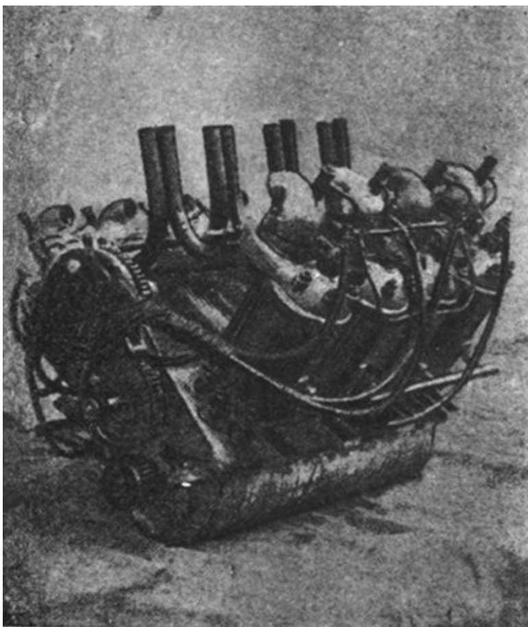
Fig. 113. — Motore da 22 HP del peso di 62 kg.
